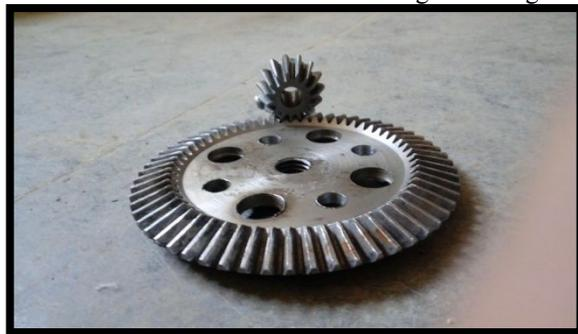
Fig. : Bevel gear
